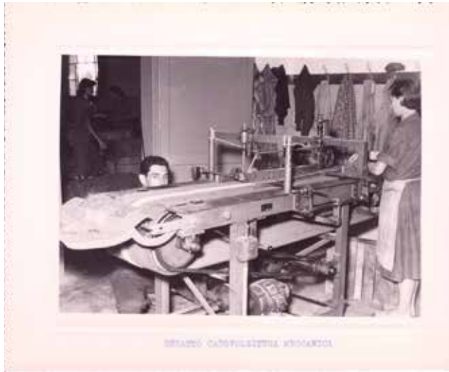
Macchina che automaticamente ordinava le setole orientando cime con cime e calici con calici [Foto Famiglia Pietro Berton]
