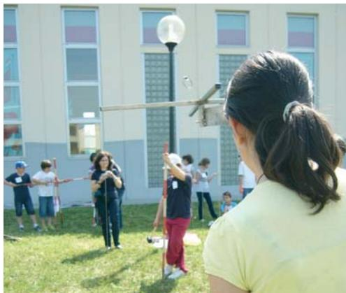
Per prima cosa abbiamo puntato il puntale nel terreno, poi abbiamo infilato l'asta nel puntale, quindi abbiamo montato la crociera, ai cui ganci abbiamo puntato i 5 fili a piombo.
